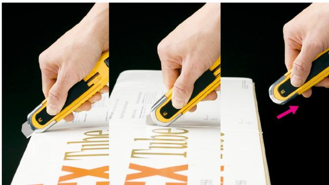
Incluso si el deslizador de la cuchilla está activado, la cuchilla se retrae automáticamente después del corte. El SK-8 de retráctil automático completo proporciona una mayor seguridad en su lugar de trabajo. El sonido de "clic" indica que se ha activado el mecanismo de retracción de la cuchilla.
