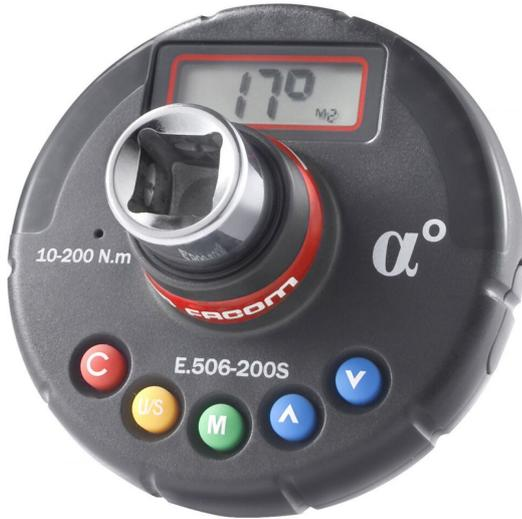
• Precisión: - Par:  $\pm 3\%$  entre 20% y 100% de la capacidad de la llave. - Angulo:  $\pm 2^\circ$ . • Modo de medición: pico o seguidor • Contador de ciclo. • Teclado bloqueable (el operador solo tendrá acceso al programa seleccionado y a la memorización de los resultados). • Unidad de medición: N.m, lbf.ft, lbf.in, Kg.cm y deg. • Preajuste posible de 9 valores de par y/o ángulo. • Memoria de 50 valores. • Suministrados en una caja de plástico con certificado de calibrado.
