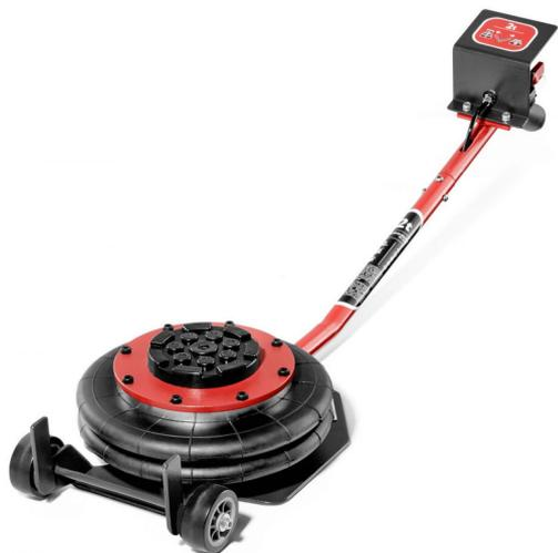
• Capacidad de carga: 2 t. • Altura de elevación máxima: 300 mm. • Altura mínima de agarre debajo del chasis: 120 mm. • Regulación de la velocidad de bajada gracias al grifo de control. • Dimensiones (L. x l.): 250 x 1055 mm. • Conformidad CE Norma EN1494+A1. • Equipado con una válvula de descarga en caso de sobrepresión de aire. • Presión mínima funcionando: 6 bares.
