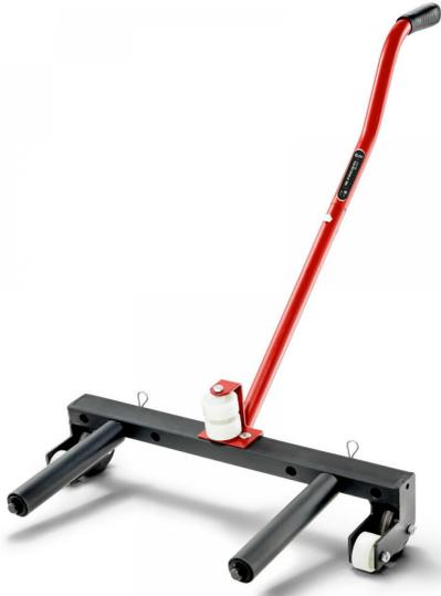
• Capacidad de carga: 250 Kg. • Permite el desmontaje-montaje fácil y seguro de las ruedas de buses, vehículos pesados, carros elevadores • 2 rodillos ajustables para una capacidad que va de 6,5" a 22,5" • 2 rodillos de largo: 280 mm
